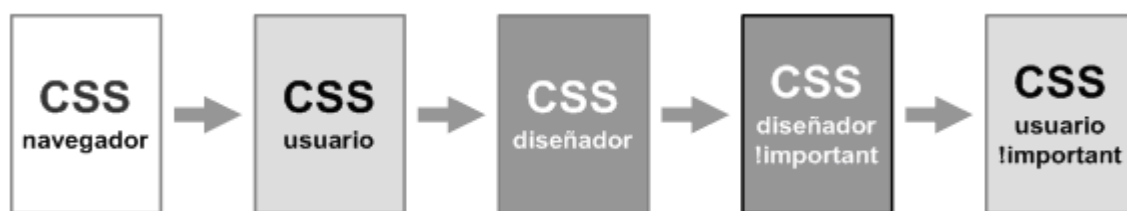
Figura 13.29. Orden en el que se aplican las diferentes hojas de estilos cuando se utiliza la palabra reservada !important
